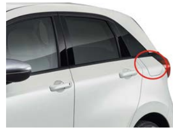
Tapón de llenado de combustible
