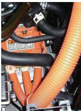
Ligação do Cabo de alta voltagem ao Motor
