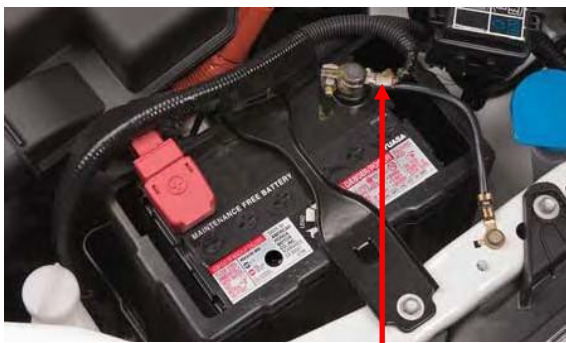
Przewody do styku ujemnego
