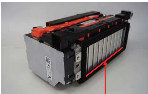
Één van vier accu "stacks"
