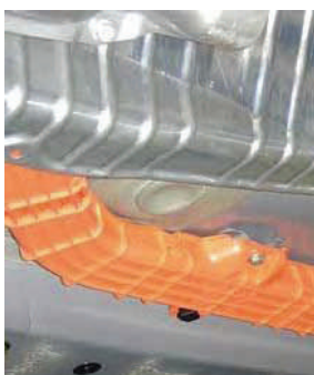
Elektrische afschermplaat aan de carrosseriebasis vastgeschroefd
