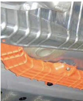
Elektrisk skjerm boltet fast i understellet
