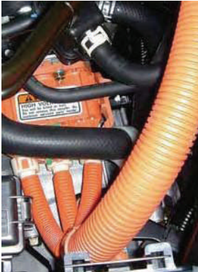
Høyspenningskabler Tilkobling til motor
