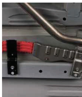
Protezione termica accanto allo scarico del caldo
