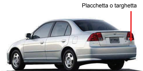
Cercare la targhetta o la placchetta Hybrid nella parte posteriore destra o sinistra all'altezza
