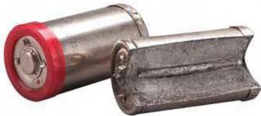
A nagyfeszültségű akkumulátor celláiban lévő elektrolit nem folyékony, és nem jelent veszélyt
