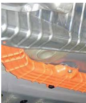
Elektromos védőburkolat az alvázhhoz csavarozva
