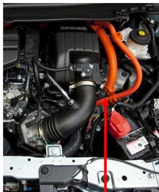
Câble haute tension relié au compresseur de climatisation sur Civic
