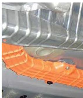
Plaque de protection électrique boulonnée au-dessous du véhicule
