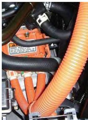
Connexion des câbles haute tension au moteur électrique
