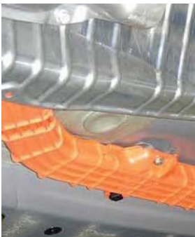
Sähköeriste ruuvattuna alustaan
