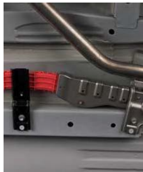
Lämpösuojus lähellä kuumaa pakoputkea
