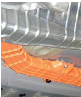
Ηλεκτρική θωράκιση βιδωμένη στο φορέα πλαισίου
