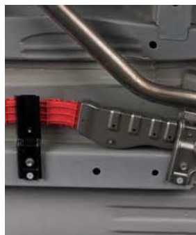
Θερμική θωράκιση κοντά στη θερμή εξάτμιση
