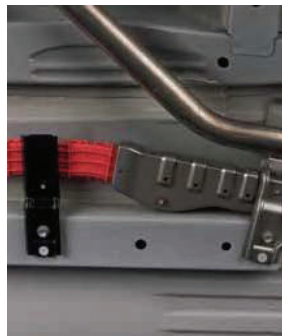
Wärmeschutzschild in der Nähe des heißen Auspuffs
