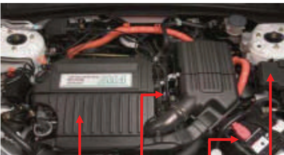
Motor Motor 12-Volt-Batterie Sicherungskasten im Motorraum
