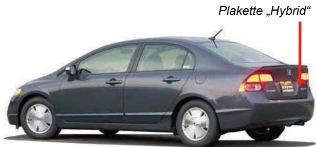
Der Schriftzug „Hybrid“ befindet sich bei diesen Fahrzeugen auf der rechten Seite des Fahrzeughecks.
