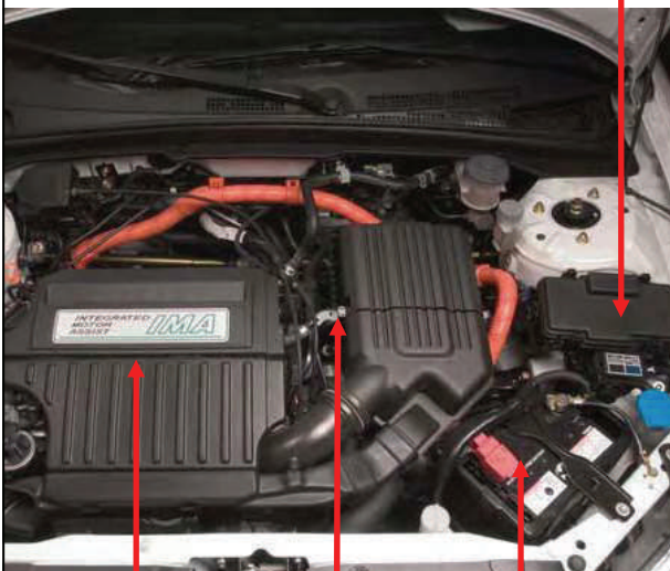
Spalovací motor Elektrický motor 12 voltový akumulátor
