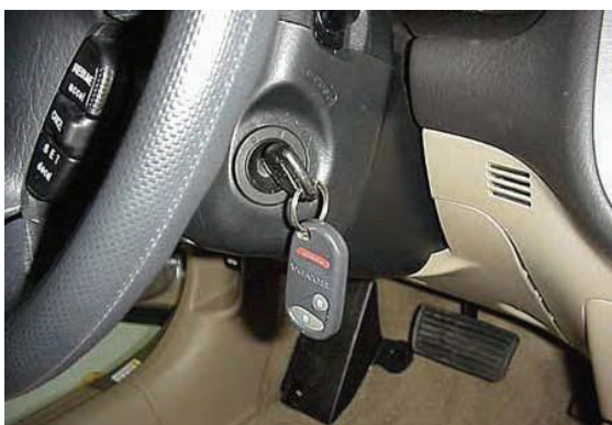
Vypnutí klíče zapalování do polohy OFF (VYPNUTO) vypne elektrický proud v kabelech.
