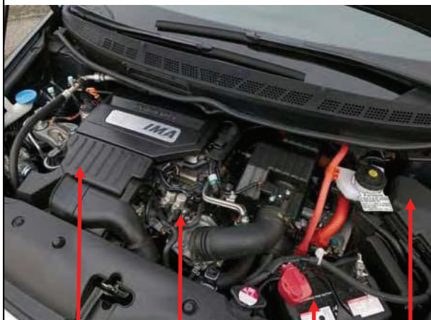
Skříňka pojistek pod kapotou 12 voltový akumulátor
